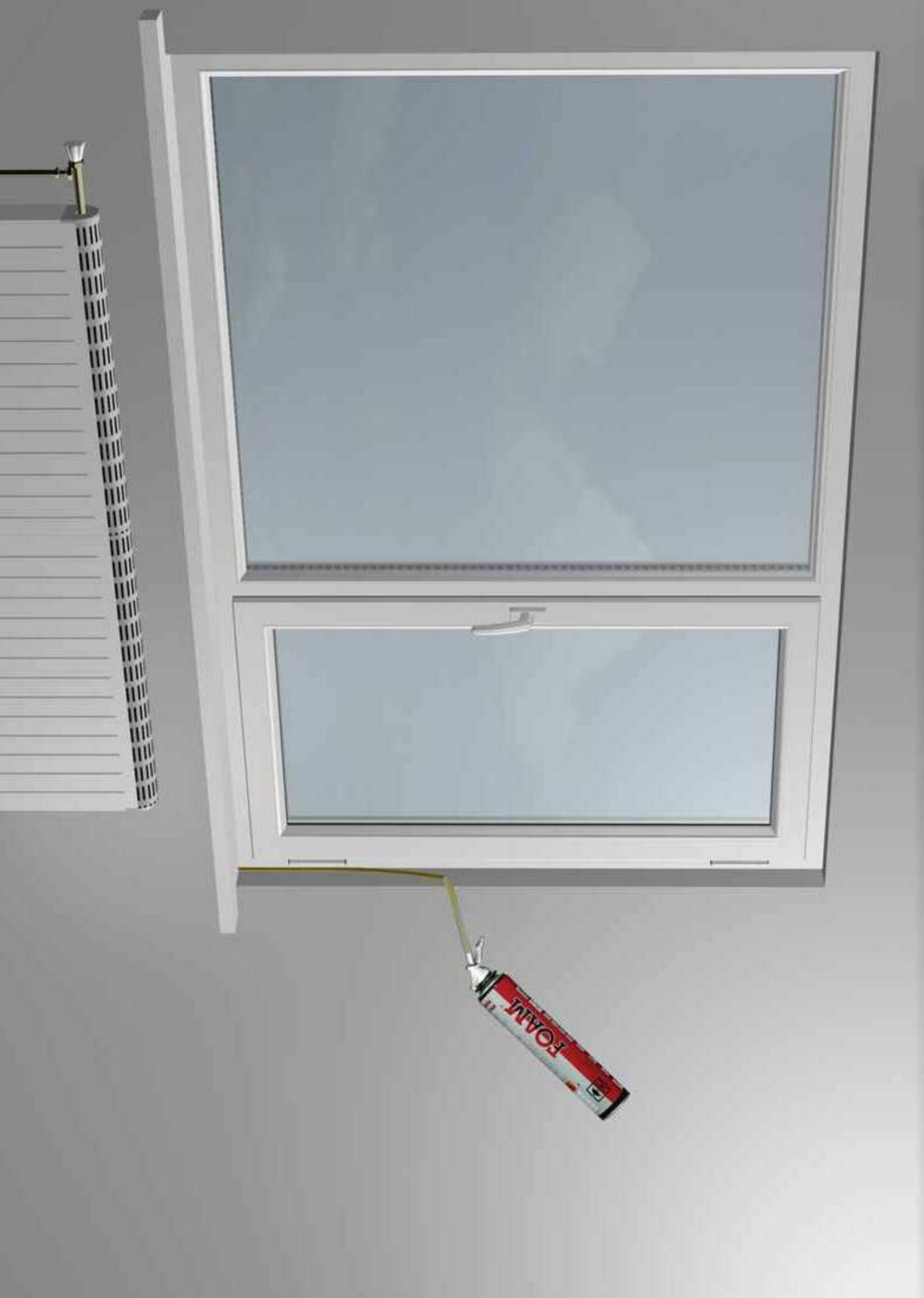
Углы между окном и стеной закрываются с помощью нанесения силиконовой мастики с внутренней и наружной стороны.
