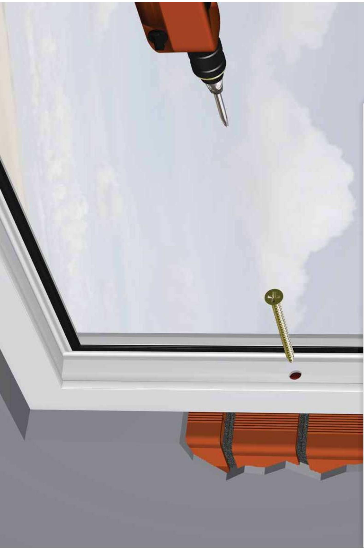
Крепление рамы к стене начинается с верхней секции, затем крепится нижняя секция и в последнюю очередь боковые секции.
